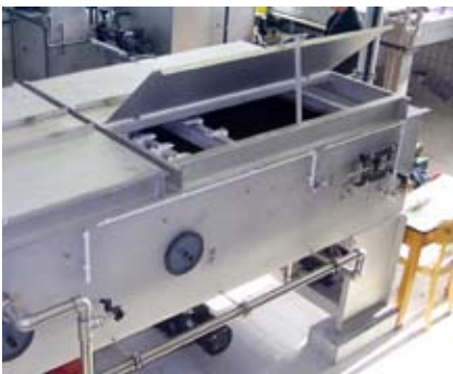
Einsatzbeispiel 2: Gekapselte Ausführung des Bandeindickers mit großzügigen Wartungsöffnungen.
