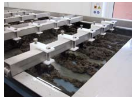
Hohe Volumenreduzierung – optimale Drainage durch Störkörper auf dem Filterband.
