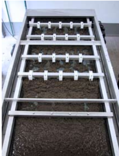
Ansicht auf dem Bandeindicker – deutlich erkennbar ist die Volumenreduzierung während des Eindickprozesses auf dem Bandeindicker.
