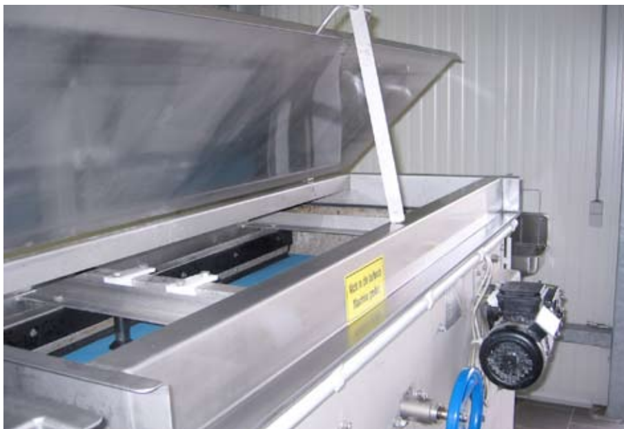
Störungsfreier Betrieb – Verschmutzungsunempfindliche Niveaumessung im Dickschlammkasten.
