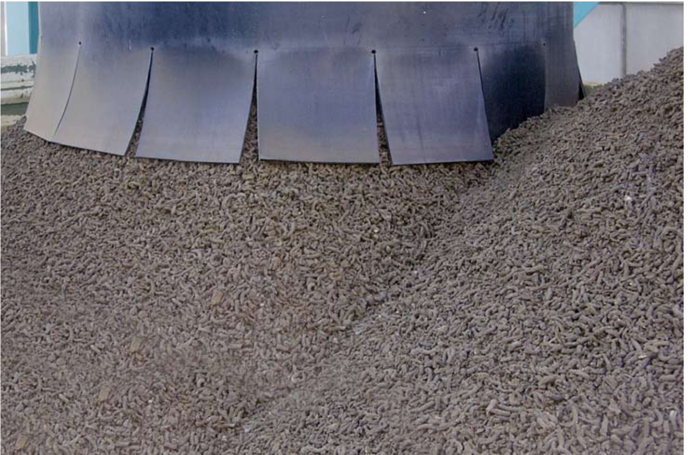
Das getrocknete Klärschlammgranulat hat einen Feststoffgehalt von mehr als 90 % - ideal für die Weiterverwertung
