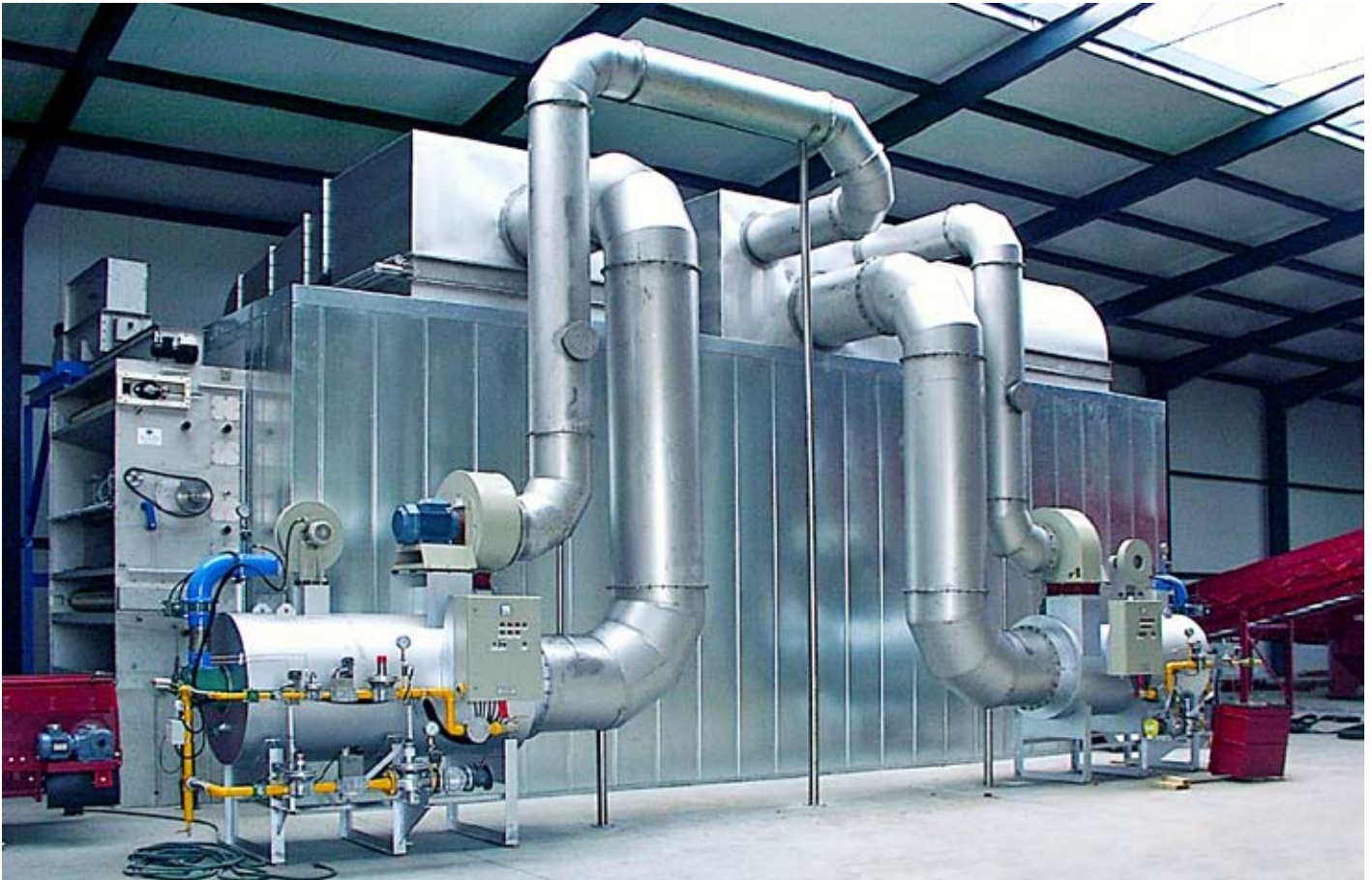
Trocknung von Gärrückständen aus einer Biogasanlage unter Nutzung anfallender Abwärme
