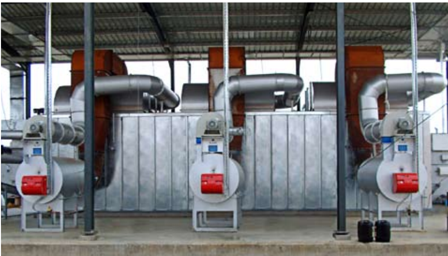
Bandrockner Pro-Dry® für kommunalen Klärschlamm, Kompletanlage mit einer Wasserverdampfungsleistung von 1700 kg/h (Saudi-Arabien)
