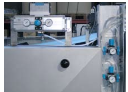
Detailsicht der Pneumatik zur getrennten Einstellung der Bandspannung für Ober- und Unterband.
