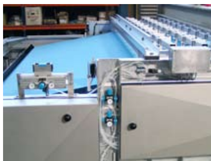
Störkörper auf der Vorentwässerungszone der Siebbandpresse zur Verbesserung der Fest-Flüssigtrennung.
