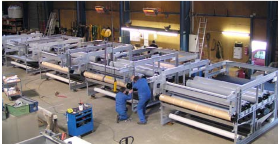
Fertigung von 4 Siebbandpressen für eine Anlage in Ägypten am Standort Deutschland, Werk Kirchen.
