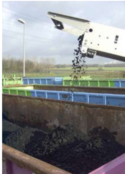
Einsatzbeispiel 3: Abwurf des entwässerten Klärschlammes in einen Abrollcontainer mittels Teleskopförderband
