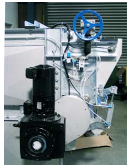
Hohe Bedienungskomfort durch z. B. pneumatisch abklappbare Schaberklingen und stufenlos einstellbarem Anstelldruck der Schaber.
