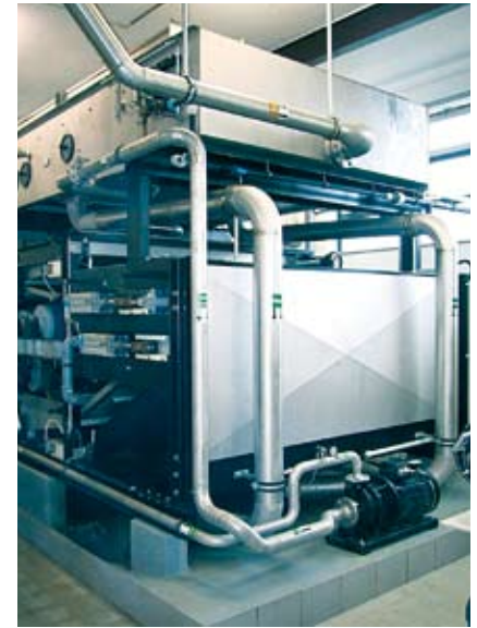
Einsatzbeispiel 4: Schlammmentwässerung mit einer Kombinationsmaschine aus Siebbandpresse mit aufgesetztem Bändeindicker.
