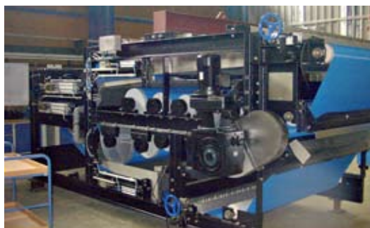
Störkörper auf der Vorentwässerungszone der Siebbandpresse zur Verbesserung der Fest-Flüssigtrennung.
