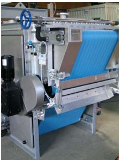
Großflächige und leicht abnehmbare Edelstahl-schutzverkleidung gemäß Unfallverhütungs-vorschriften.
