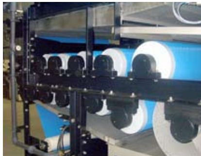
Anordnung der 12 - 14 Presswalzen am Maschinenrahmen der Siebbandpresse.
